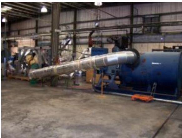
Test échangeur thermique A380 A380 heat exchanger test
